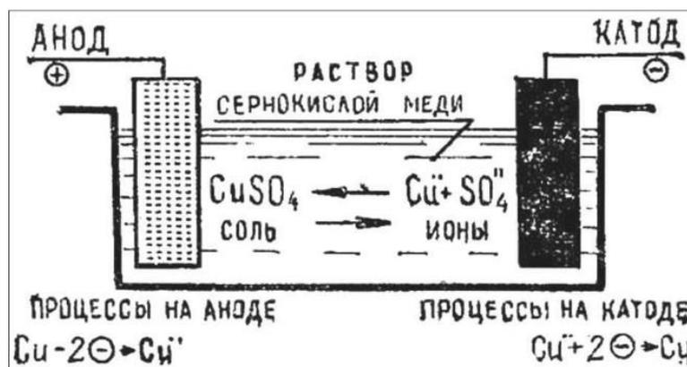
Рисунок 1. Технология нанесения медного гальванического покрытия
