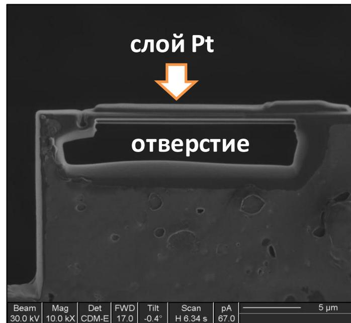
Формирование отверстия на краю образца и нанесение слоя платины
