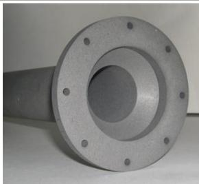
***Длинномерная деталь из пористого нанобериллия. Длина трубчатой части – 600 мм, диаметр – 40 мм, плотность – 0,27 г/см<sup>3</sup>. Диаметр фланца – 108 мм, толщина – 8 мм, плотность – 0,40 г/см<sup>3</sup>. Прочность при сжатии материала: в трубчатой части – 24 МПа, во фланцевой части – 45 МПа.***
